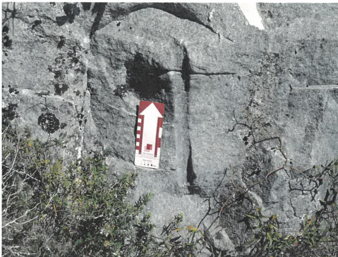
Fot.15 – Explorações da Barrosinha (n.º4) : sulcos provenientes das cunhas.
